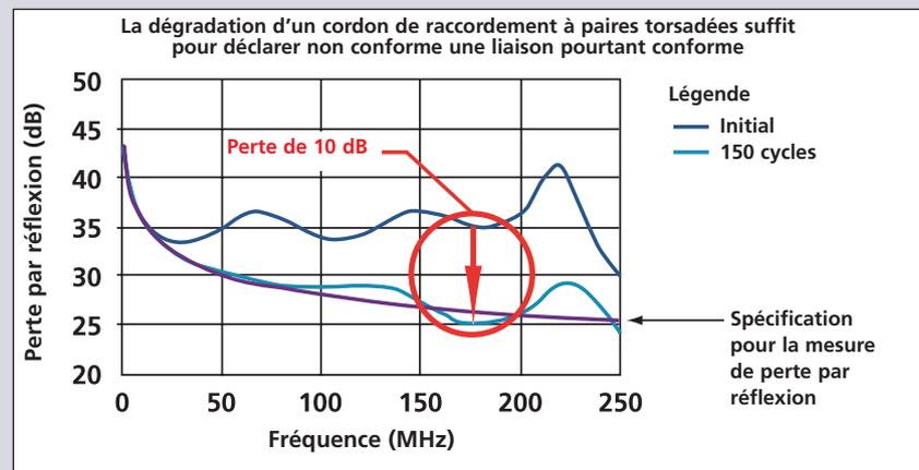
Comme le montre ce graphique, un cordon SFTP de Cat. 7 vendu dans le commerce affiche une perte par réflexion de 10 dB au bout de 150 bobinages et débobinages. Cette dégradation de 10 dB suffit à déclarer non conforme une liaison conforme. Vous vous basez alors sur un résultat erroné. L'adaptateur PLIA de Fluke Networks élimine cette perte de 10 dB et garantit la fiabilité et la précision des résultats du testeur DTX.
