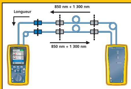
Contrairement aux adaptateurs de test des fibres optiques concurrents, qui mesurent la longueur et qui effectuent **deux** mesures de perte par Autotest, les solutions DTX sont les seules à mesurer la longueur et à effectuer **quatre** mesures de perte par Autotest et ce, en l'espace d'environ 12 secondes. Les modules fibres optiques DTX vous permettront d'effectuer vos tests cinq fois plus rapidement qu'avec des modules concurrents.
