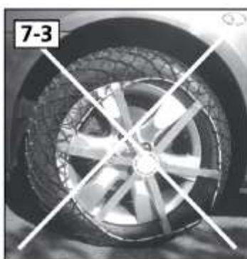
Centrage extérieur incorrect
