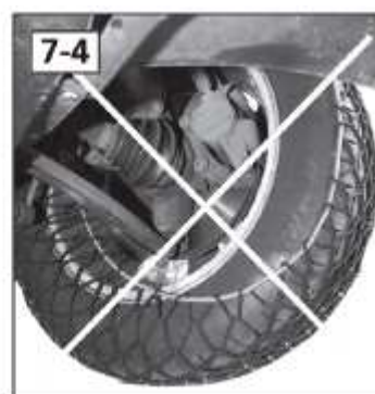
Centrage intérieur incorrect
