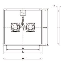
Câble de raccordement 220V~16A, prise type C13. Boîte de cordon de secteur : 1.2mm d'épaisseur. Plateau ventilateur : 0,8mm d'épaisseur. Matériau : acier laminé à froid. Couleur : noire. La référence 71155 est dotée de 4 ventilateurs et la 71440 de 6 ventilateurs.
