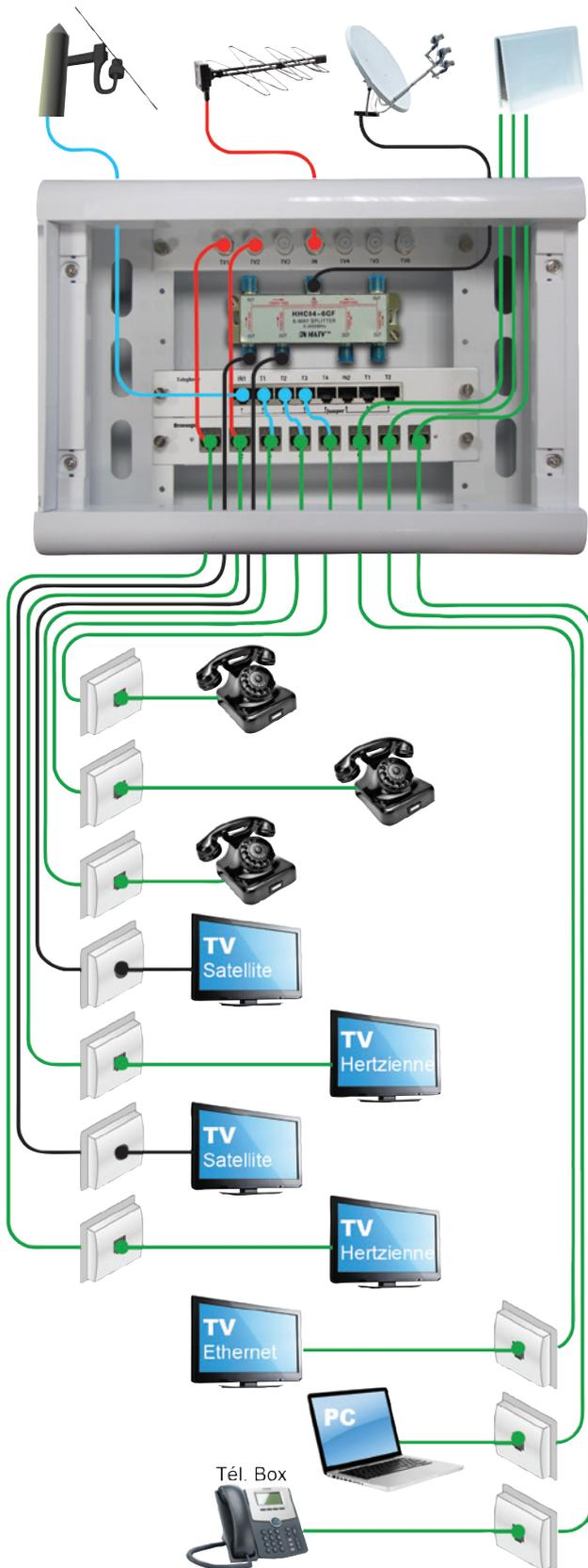
5. L'installation nécessitera également les composants permettant de relier les points de câblage du coffret aux prises terminales dans le logement : câbles, connecteurs et plastrons non fournis dans ce kit.
