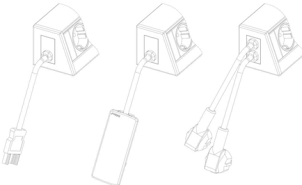
Bouchon de fin avec câble de raccordement au réseau fixe.
