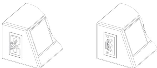
Bouchon de fin avec connecteurs enfichables (Wieland GST 18i3 ou WAGO WINSTA) entrée et sortie courant
