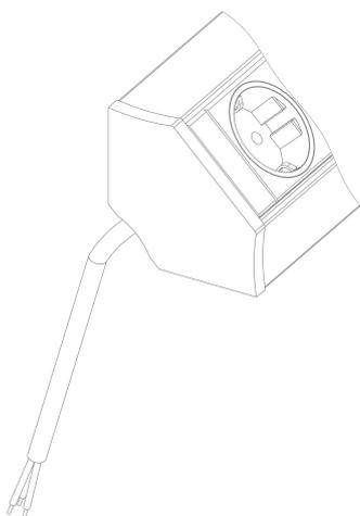
Bouchon de fin avec connecteur entrée et sortie du courant réalisable.
