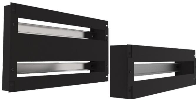
Bandeau décaissé avec rail DIN pouvant accueillir suivant le modèle un maximum de 24 ou 48 modules. Le tout est fourni avec la visserie nécessaire à la pose dans un coffret ou une baie 19 pouces. Matériau : acier laminé à froid d'épaisseur 1,2mm. Couleur : noire.
