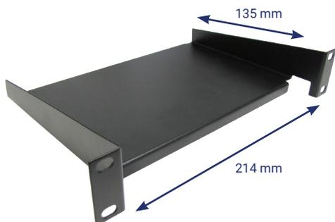
Cette tablette 1U 10 pouces est idéale pour accueillir de petits appareils réseaux tel que modem, switch... La tablette a une profondeur utile de 135mm pour une profondeur totale de 160mm. Elle est en acier laminé à froid d'épaisseur 1,5mm et de couleur : noir. Cette tablette est compatible avec le coffret 10" 71656.
