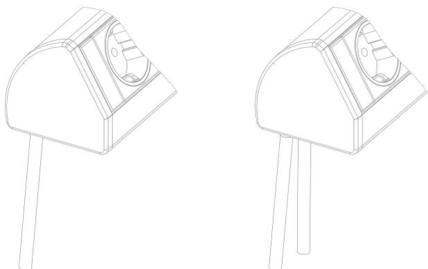
Câble de raccordement réseau fixe en bas venant du profil.
