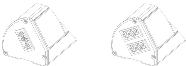
Bouchon de fin avec connecteurs enfichables entrée et sortie courant réalisable.
