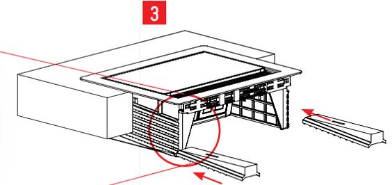
3 Insérer les deux cales de fixation jusqu'au point de verrouillage
