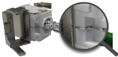
Drain de masse sur le passe-fils.
