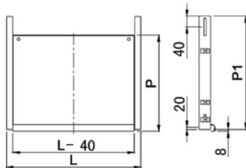
Tablettes clavier pour baie 19". Matériau : acier laminé à froid d'épaisseur 1,2mm. Section rail coulissant : 14". Longueur de flexion 210mm. Charge admissible : 20kg. Couleur : noire.
