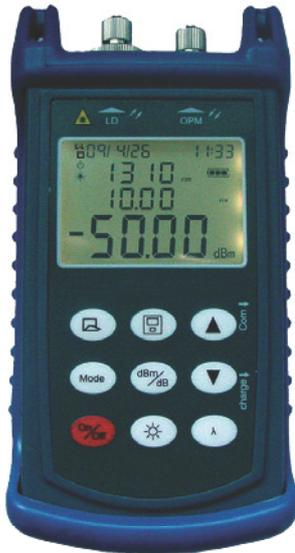
Les Multi-Wattmètres PLATINE RÉSEAUX OPTIQUES® combinent les fonctions de source laser et de wattmètre. Ils permettent des mesures de test précises sur de multiples longueurs d'onde. Les Multi-Wattmètres PLATINE RÉSEAUX OPTIQUES® sont largement adaptés à des projets de télécommunications optiques, système CATV, développement de projets de laboratoire, etc.
